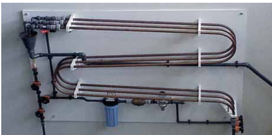
Koperen buizenopstelling voor het meten van het koperoplossend vermogen van drinkwater.
